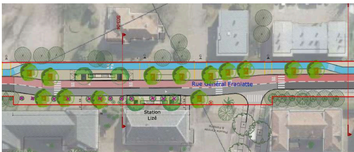
Station Lizé: absence de bandes d'éveil de vigilance au droit des traversées pour piétons.
